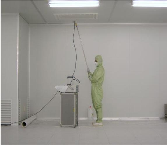
TAB(LEAK TEST) 측정
